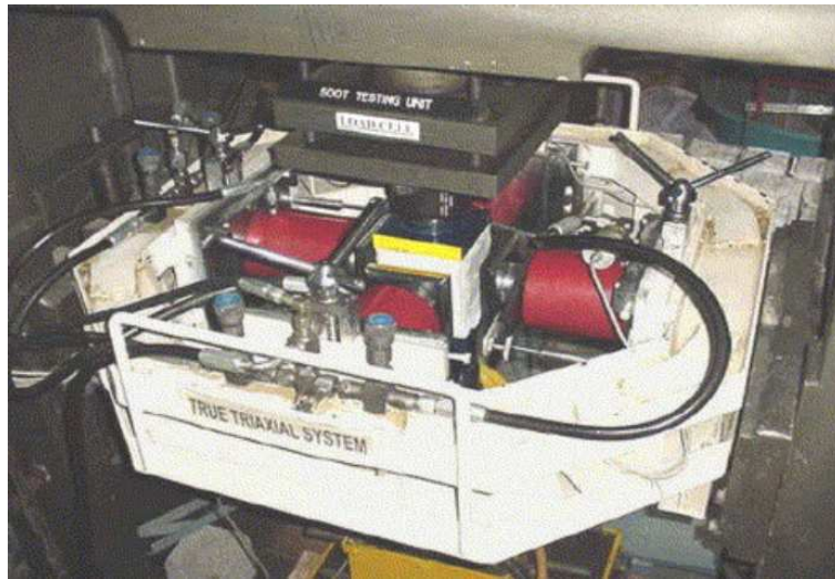
FIGURE II.1.4 – Dispositif polyaxial, équipé de trois paires de pistons rigides, développé par Rao and Ramana (1994).
