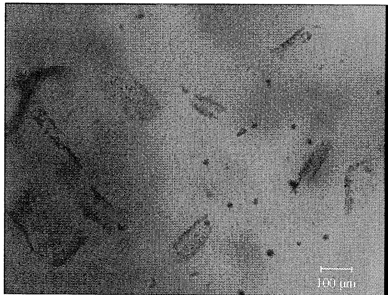
figure II-24 Inclusions regroupées en amas (ref. BV I-3 recuit un mois)
