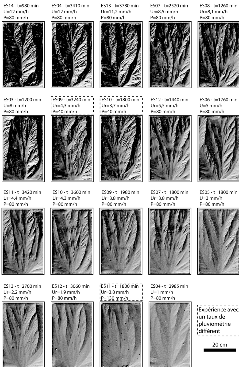
Figure IV-22 : Comparaison des topographies (MNT) à l'équilibre pour l'ensemble des expériences classées en fonction de la rugosité estimée visuellement du relief (même exagération verticale pour l'ensemble des topographies x2).
