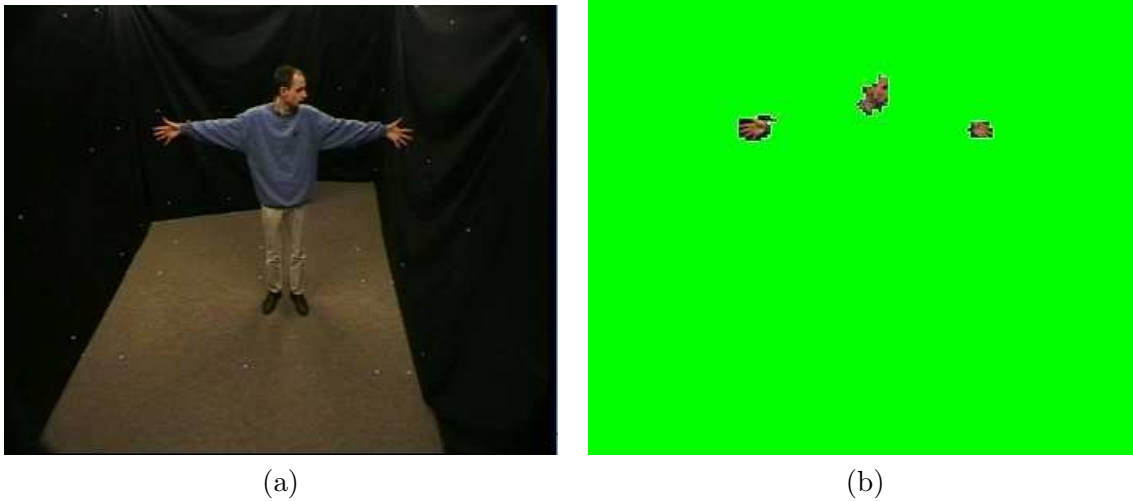
FIG. 4.9 – Exemple de détection de peau dans l’espace couleur YCbCr . (a) image originale, (b) pixels de peau.
