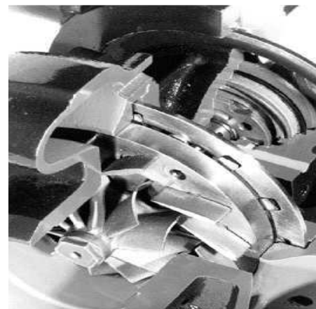
Turbine à géométrie variable
