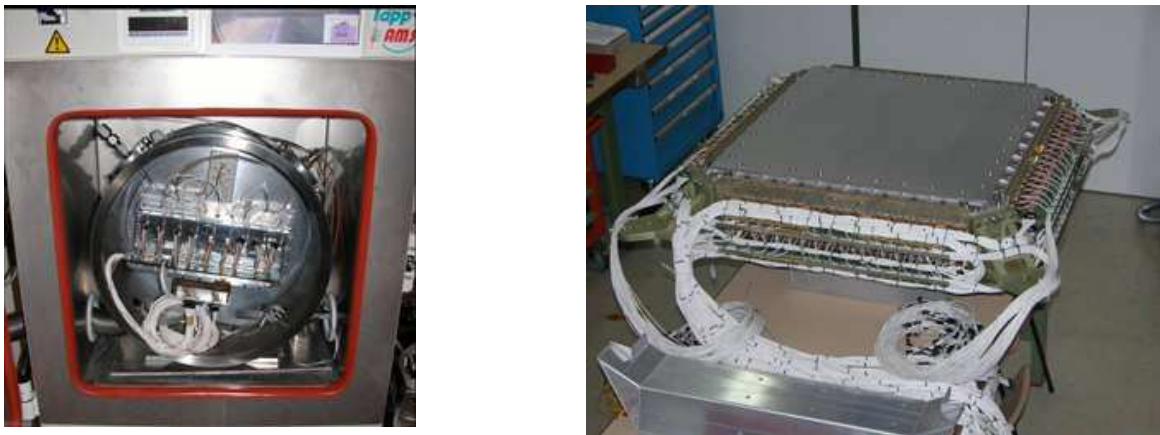
FIG. 6.27 – Enceinte de vide thermique (à gauche) et modèle de vol du calorimètre instrumenté (à droite).
