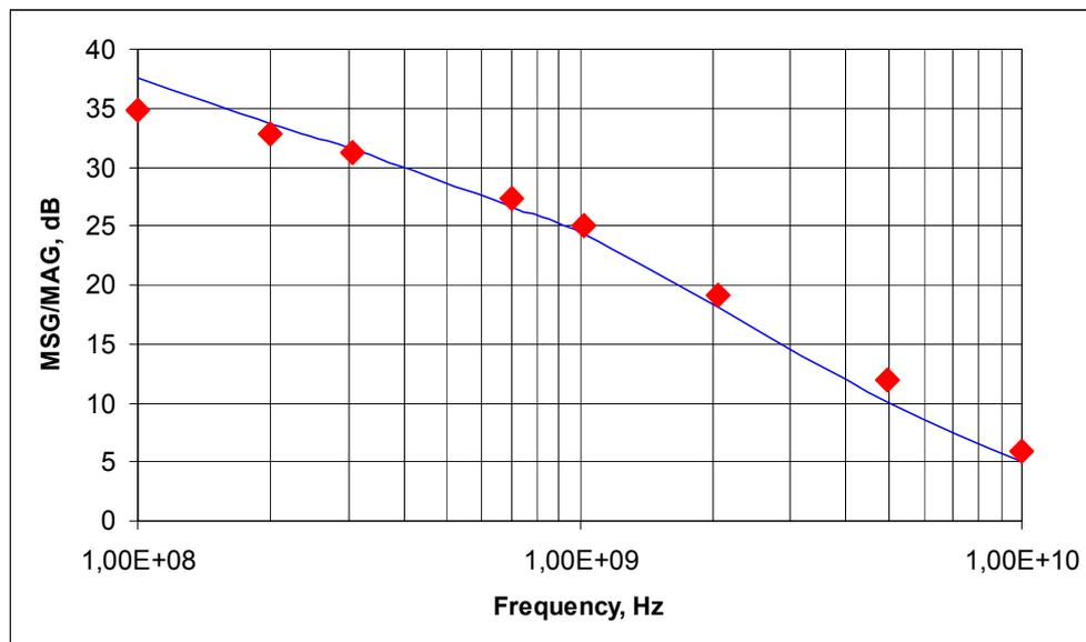
Figure 68 : Gain en puissance pour  $R_{th}=150^\circ\text{C/W}$
