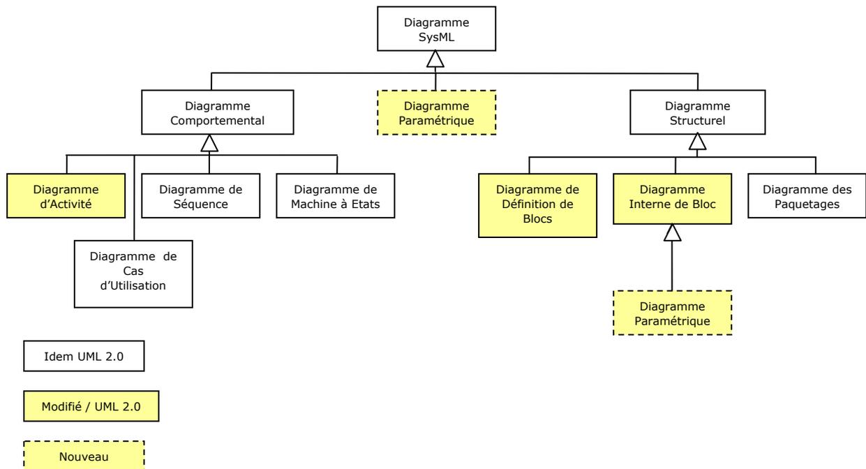
**Figure 19 : Les différents diagrammes SysML 1.0**
