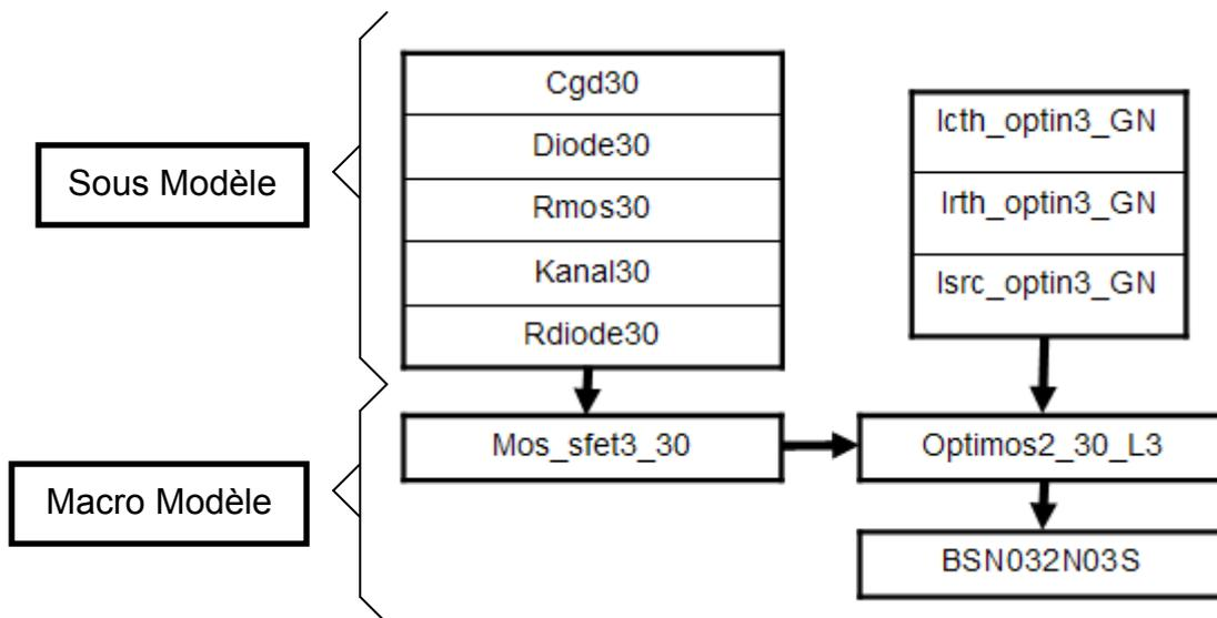
Figure 70 : Décomposition en sous modèles du modèle OptiMOS (BNS032N03S)
