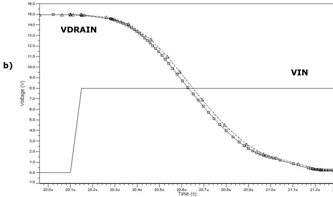
**Figure 72 : L'OptiMOS a) en mode commutation
