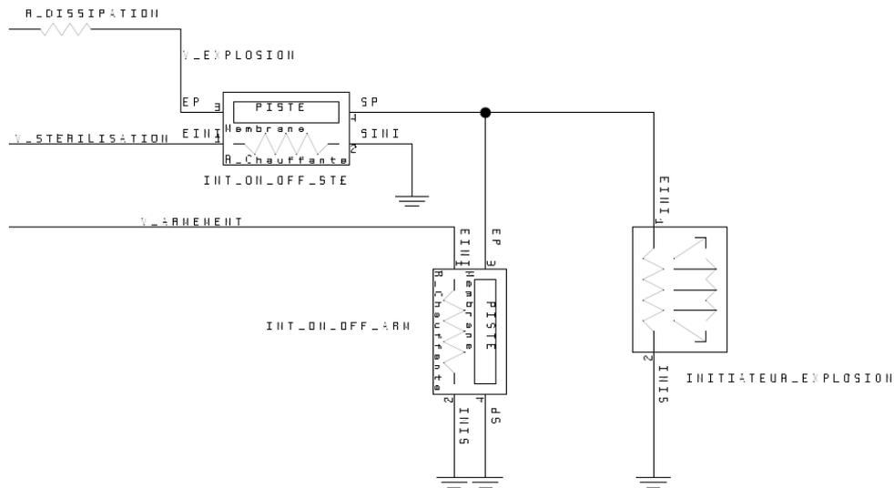
Figure 51 : Modèle de la partie sous système pyrotechnique
