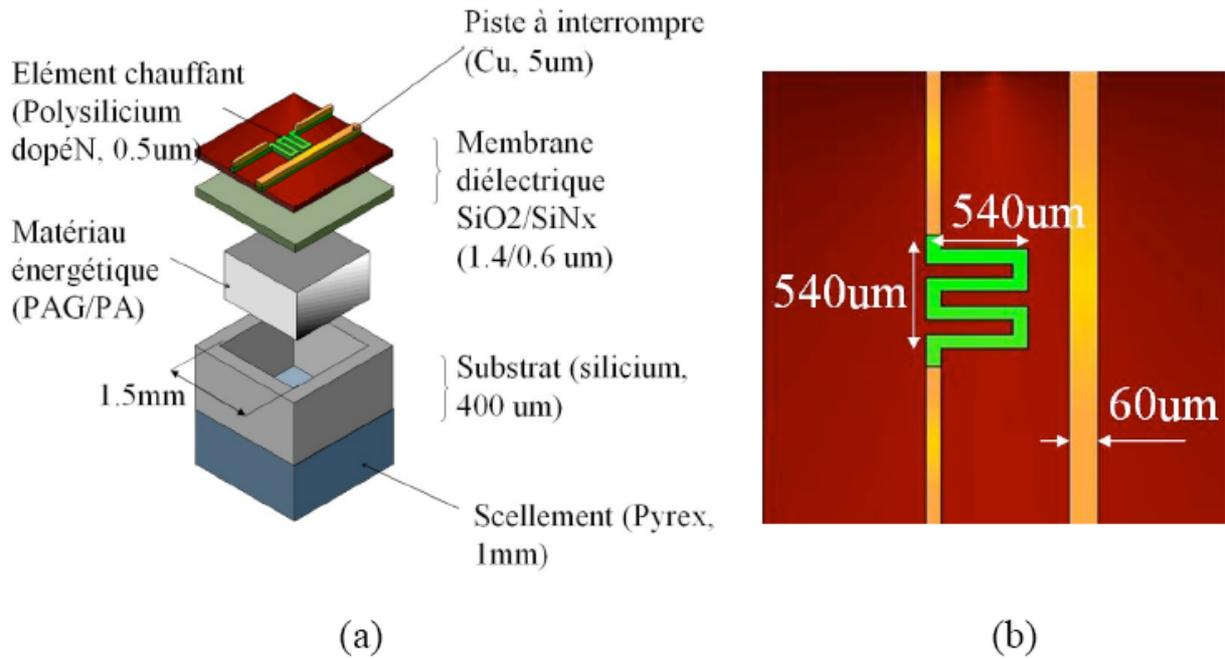
**Figure 45 : Dispositif Original PYROSECURE pour la fonctionnalité Interrupteur ON-OFF pyrotechnique : (a) vue éclatée indiquant les couches et leurs épaisseurs (b) vue de dessus avec les cotes (Source [Pen06])**
