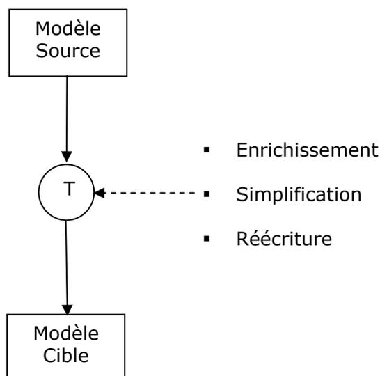
**Figure 7 : Processus élémentaire de Transformation de Modèle**
