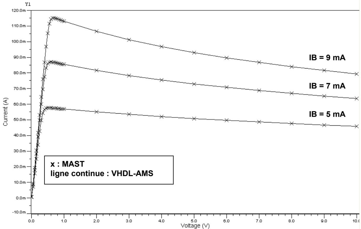
Figure 67 : Caractéristiques ( $I_c, V_{ce}$ ) avec résistance thermique =  $150^\circ\text{C/W}$
