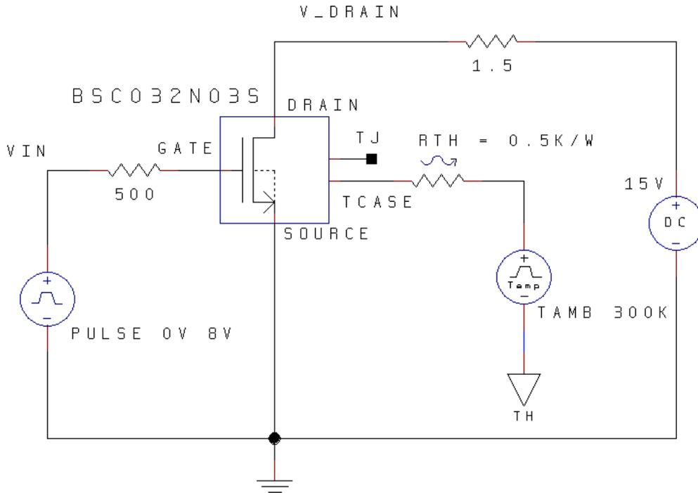
Figure 71 : Banc d'essai du BSC032N03S en mode Commutation
