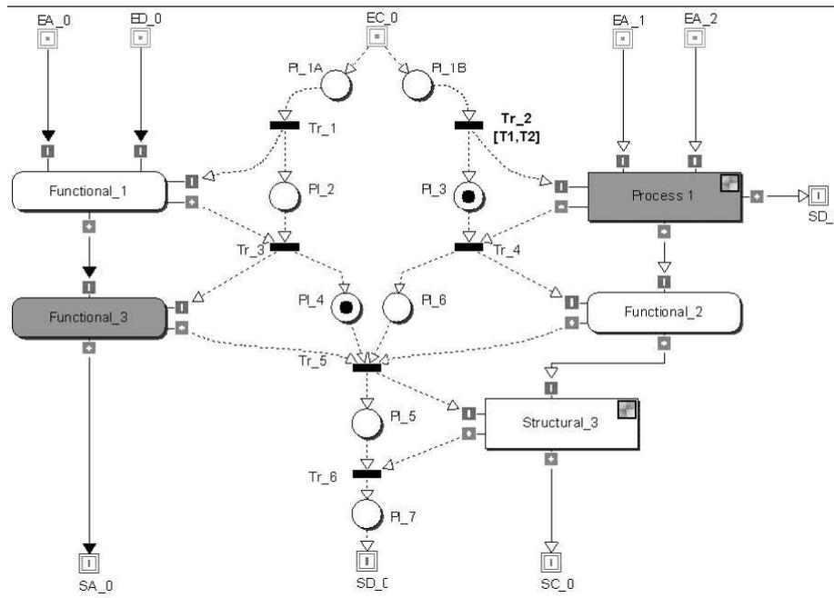
**Figure 37 : Intégration du réseau de commande et blocs dans une architecture HiLeS**
