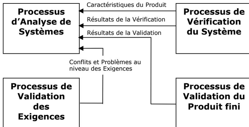
Figure 21 : Processus d'Evaluation Technique selon l'EIA-632
