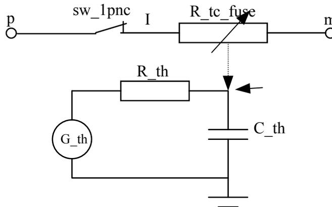
**Figure 76 : Structure du modèle de Fusible**
