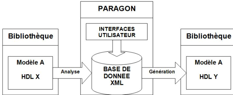
**Figure 29 : Principe de Fonctionnement du logiciel Paragon**
