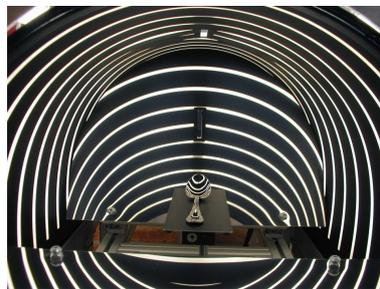
**Figure 2.19** – Prototype d'inspection de surfaces parfaitement spéculaires [Seulin, 2002].
