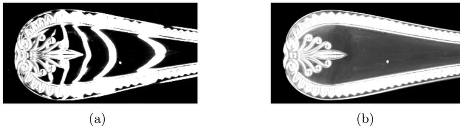
**Figure 5.23** – Détection de défauts d'aspect sur des objets métalliques spéculaires : (a) effets de l'éclairage structuré au niveau des décors, (b) image d'aspect.
