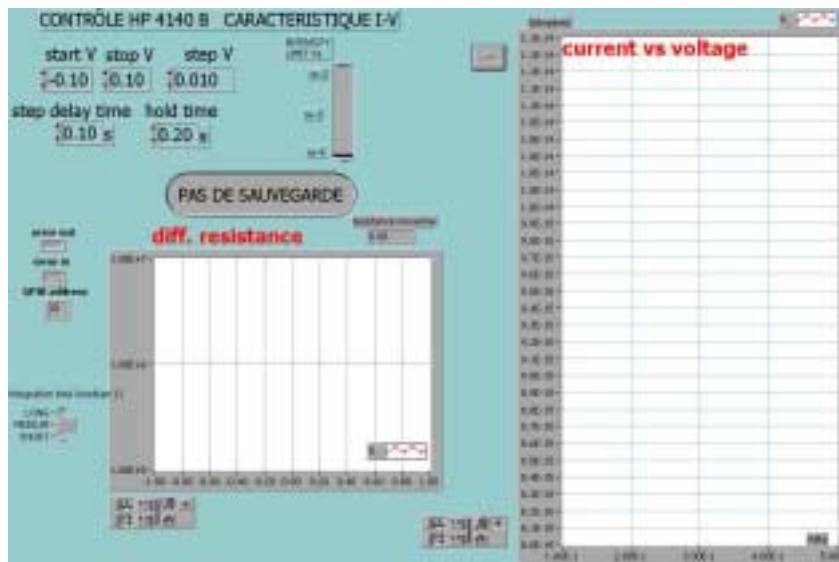
Figure 3: Interface LabView utilisée pour piloter le picoAmpèremètre HP4140B. (a) Interface I-t permettant d'enregistrer le courant traversant le fil au court du temps. (b) Interface (I-V).
