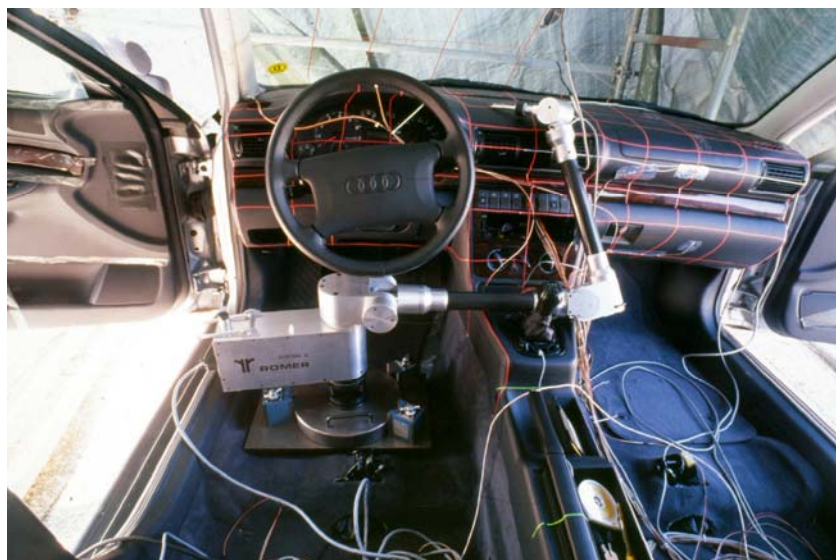
Figure 18 : Maillage 3D de l'intérieur d'un habitacle automobile
