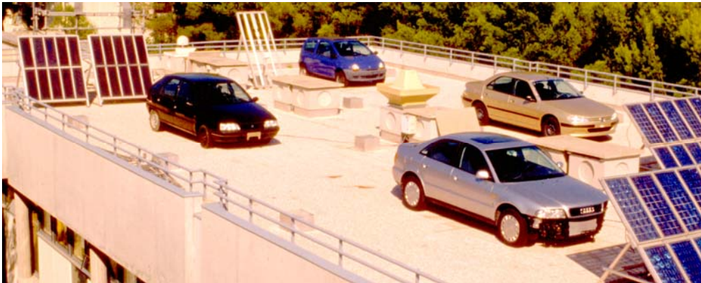
Figure 17 : 4 véhicules en essais de confort thermique en conditions naturelles
