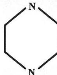
Le composé V<sub>2</sub>O<sub>5</sub>-0,5 pipérazine préparé récemment par Riou et Férey <sup>[2]</sup> subit une décomposition très nette sous oxygène à la température de 320°C. La variation de masse correspondant à l'élimination de l'amine protonée est de 22 %.
