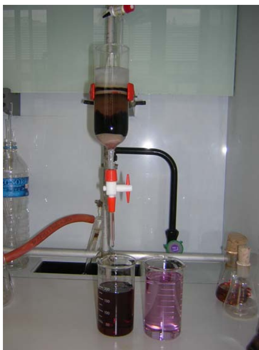
Figura 21. Separarea pe coloana cromatografica a amestecului de reactie
