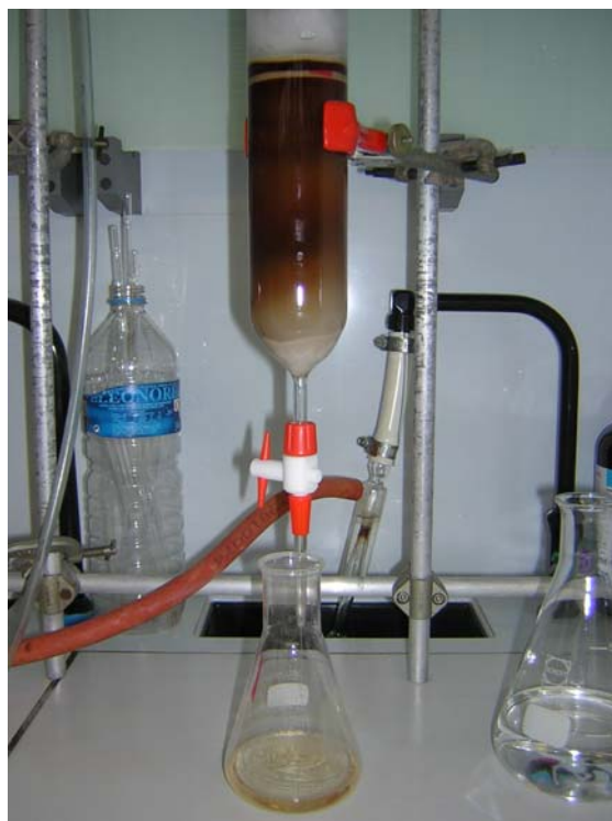
Figura 36. Separarea pe coloana cromatografica a derivatilor de metano-fulerena.
