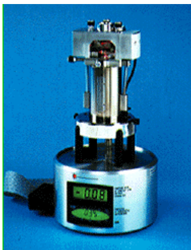
Figura 7. Imaginea unui aparat AFM
