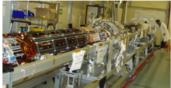
FIGURE 3.6 – Gauche : représentation schématique du détecteur de vertex à pixels. Droite : vue du détecteur de vertex à pixels, placé autour du tube à vide du LHC, lors de la connexion des derniers services en février 2007.
