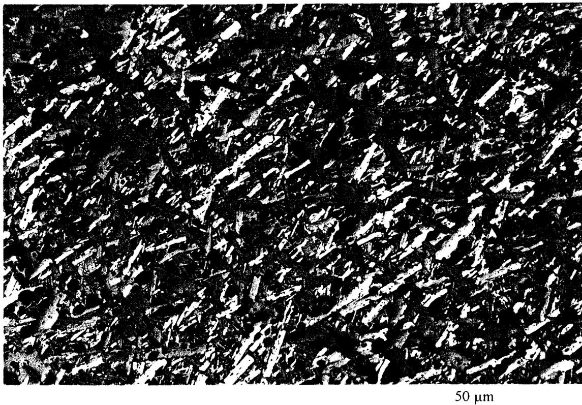
**Figure IV.16.: "Gros grains" en forme de plaquette dans la partie basse, non texturée, de la pastille A (microscopie optique en lumière polarisée)**
