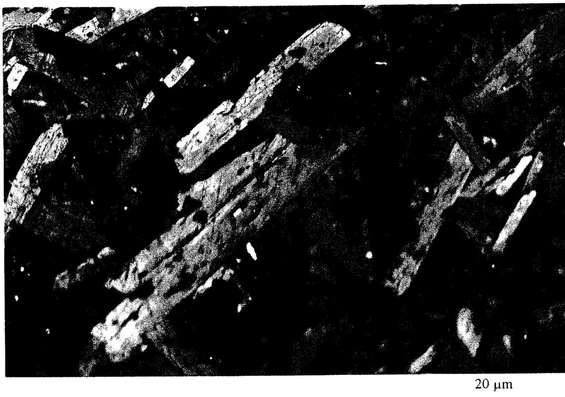
**Figure IV.20.:** Microcristaux en forme de plaquette dans la partie basse, non texturée, de la pastille A, juste au dessous de l'interface (microscopie optique en lumière polarisée)
