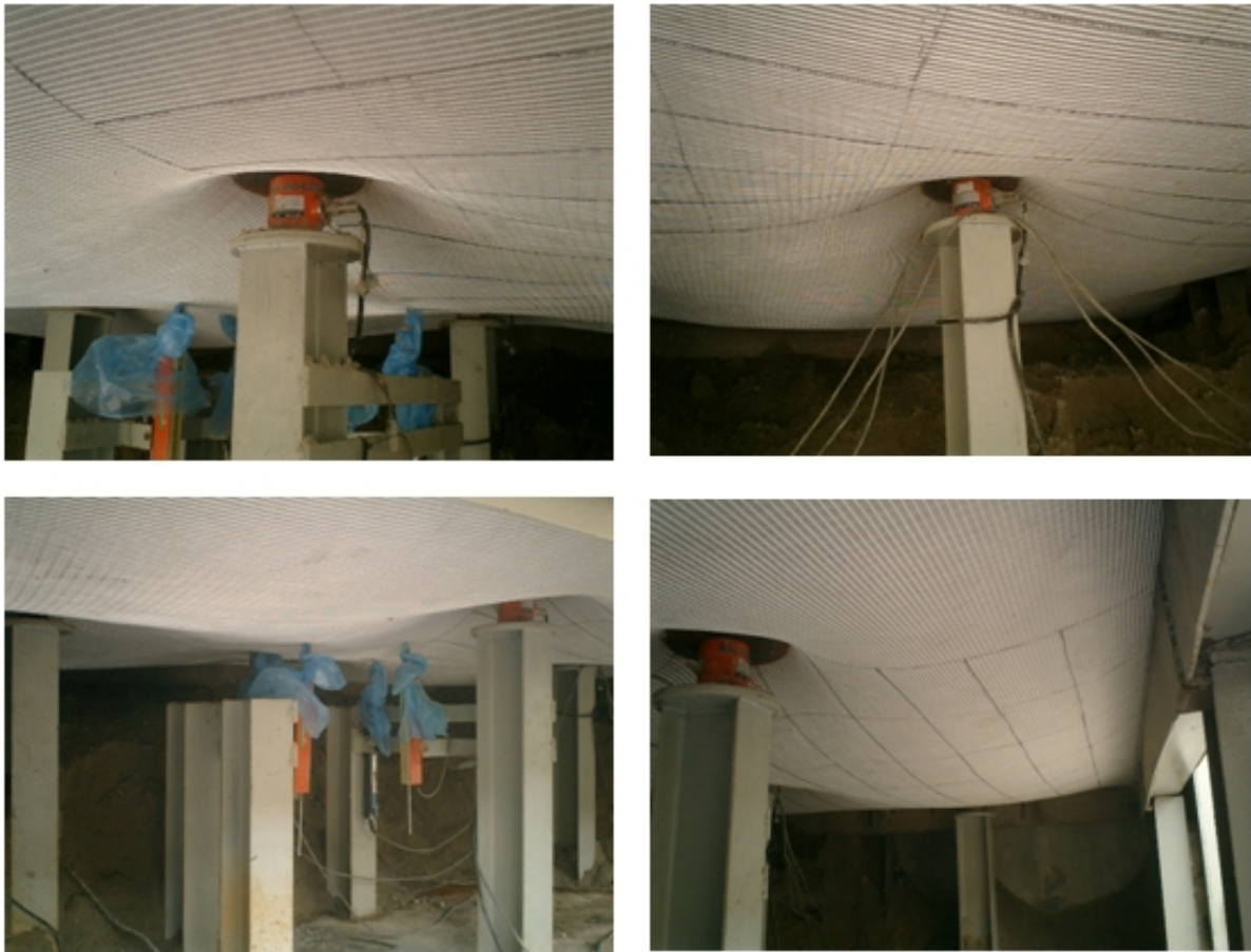
FIG. 3.4 – Effet membrane du géosynthétique.
