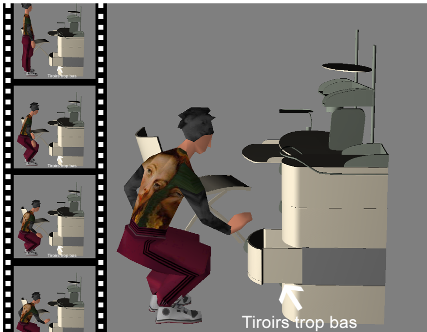
Figure 34 : exemple d'annotation gestuelle. L'utilisateur veut indiquer la posture nécessaire pour atteindre les tiroirs inférieurs.
