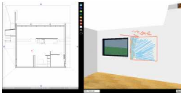
Figure 33 : utilisation d'une marque 3D dans l'environnement SpacePen [Jung & al. 02a]. La marque a une fonction représentative (la fenêtre est dessinée) et une fonction symbolique (la flèche et le mot « move » indiquent l'idée de déplacer la fenêtre)
