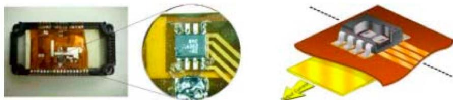
**Figure 23** utilisation des possibilités d'un capteur de champ à magnéto-résistivité pour la réalisation d'un capteur de courant
