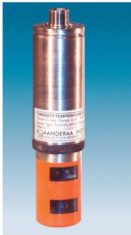
FIGURE 7.2.2: Photographie d'un turbidimètre, d'après Mylvaganam & Jakobsen (1998).
