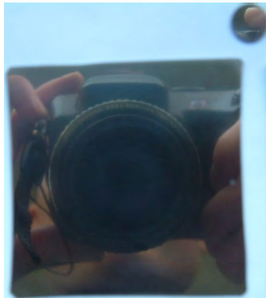
Fig. III.5 – Un rotor en NdFeB et une plaquette en \text{SmCo}_5 mécaniquement polis
