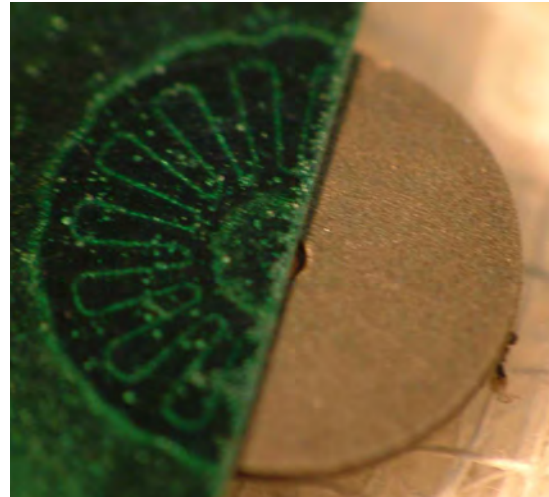
Fig. II.1 – Rotor avec une couronne uniforme aimanté autour de son périmètre
