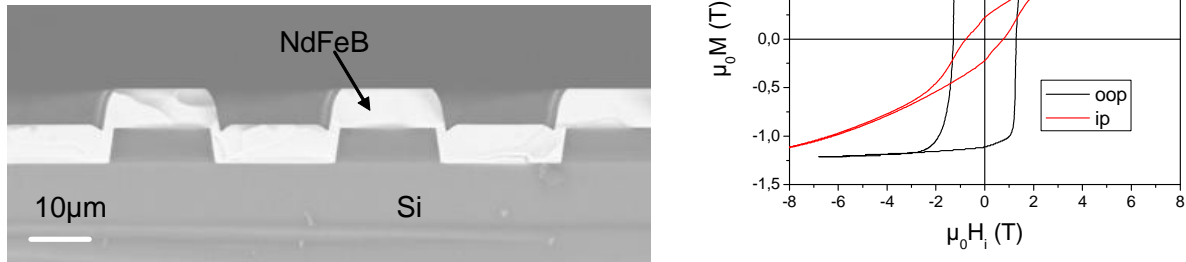
Fig. III.18 – à gauche: NdFeB déposé au LLN dans des \mu -caissons; à droite: caractéristique mesurée du NdFeB déposé en couche épaisse.
