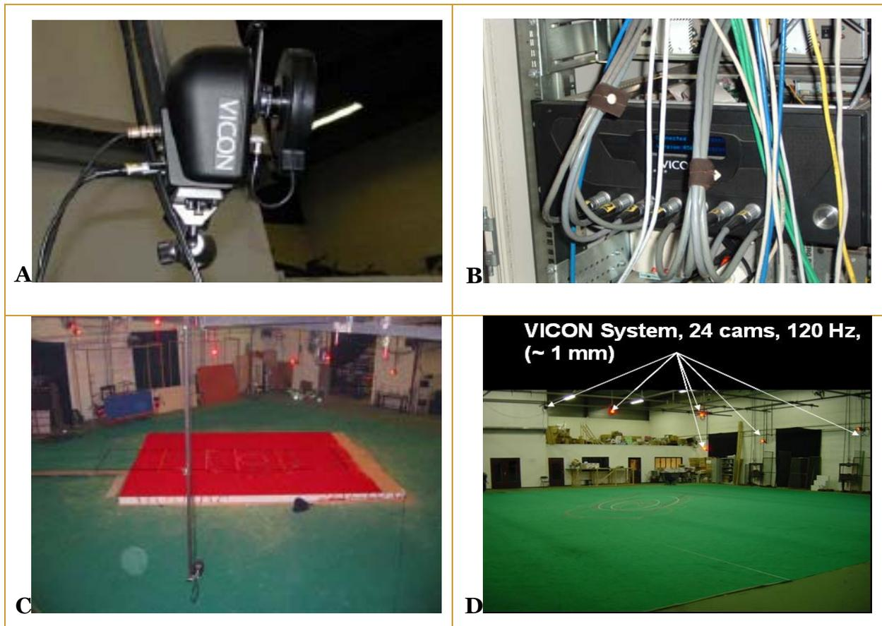
**Figure 17 : A) Caméra Vicon utilisée B) Centrale Vicon récupérant les données de 24 caméras par groupes de 3 C) et D) Premiers lieux d'expérimentations à Fontenay sous Bois chez la société Atopos (S. Dalbéra).**
