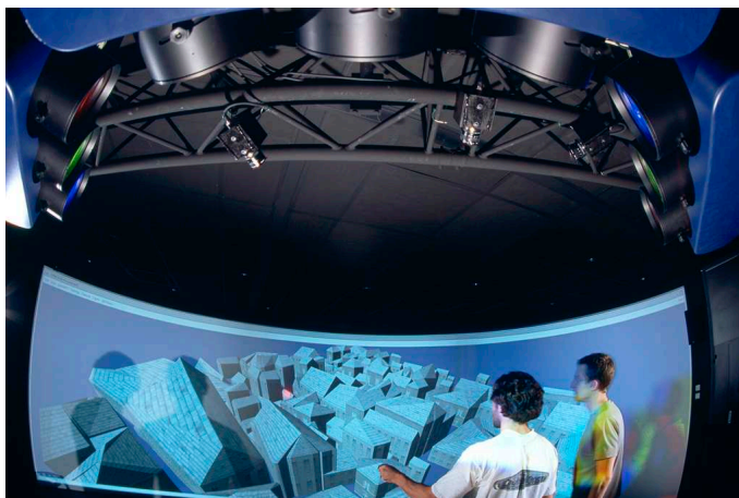
Figure 1.6 – Projection d'images sur un mur hémicylindrique
