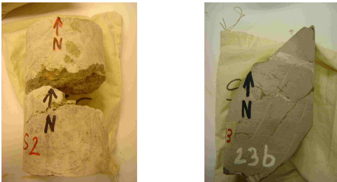
FIG. 3.3 – Carottes utilisées pour les mesures de conductivité thermique.
