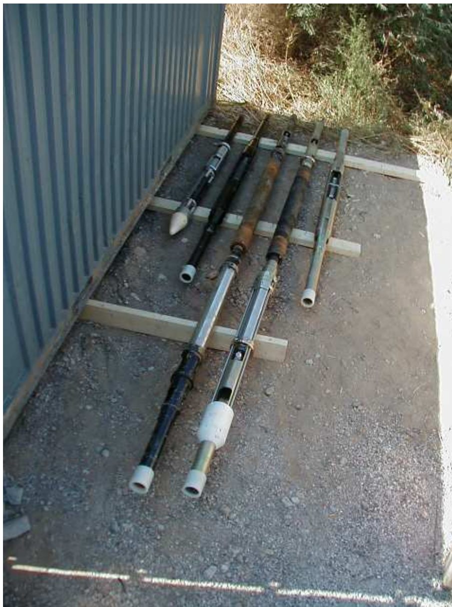
FIG. 4.2 – Les 5 boîtiers d'acquisition en attente de leur installation dans le forage AIG10, en septembre 2003. De gauche à droite : boîtier fond, boîtier faille inférieur, boîtier HPSup et son obturateur au fond, boîtier HPSup et son obturateur et boîtier haut. Les boîtiers les plus longs font près de 5 m.
