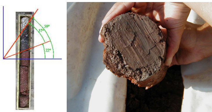
FIG. 2.12 – La carotte de la faille est présentée dans la figure de gauche. On y aperçoit deux discontinuités : entre les calcaires et la gouge argileuse grise puis entre cette gouge argileuse et une argile siliceuse, sans doute issue des radiolarites advectées par le mouvement de la faille. Sur cette dernière, des striations de glissement sont encore bien visibles, à droite. Noter les angles différents observés.
