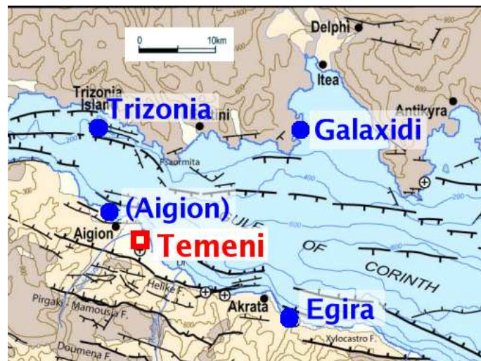
FIG. 6.3 – Ensemble des capteurs permettant d'interpréter les marées enregistrées sur le capteur d'Aigion. Les cercles bleus signalent les marégraphes et les carrés rouges les capteurs de pression barométrique.
