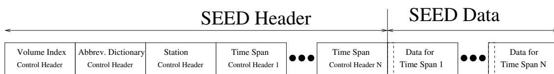
FIG. B.1 – Structure d'un fichier SEED.
