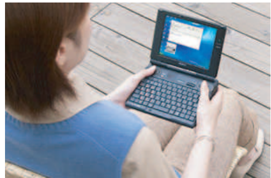
FIG. 2 – Plus petit micro-ordinateur : le Sony® Vaio U3, 816 grammes, processeur à 933MHz, 20 Go de disque dur, 512 Mo de mémoire vive
