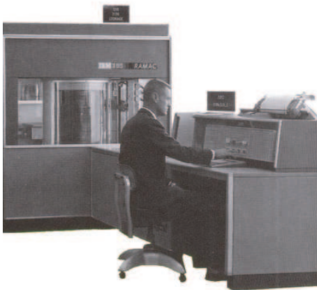
FIG. 1 – En 1956, IBM® lance le 'IBM 305 RAMAC' : premier ordinateur avec disque dur d'une capacité de 4.4 Mo
