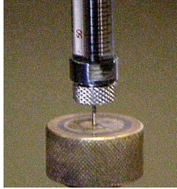
Figure 3-13 : Injection du fluide caloporteur avec une micro-seringue
