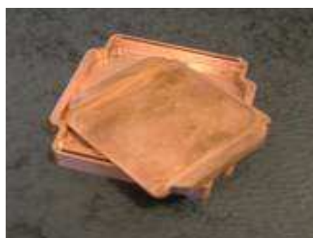
Figure 4-1 : Demi caloducs en Glidcop avant l'assemblage
