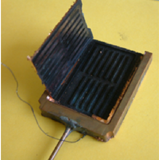
Figure 4-14 : Le prototype 3 ouvert après plusieurs cycles gel-dégel
