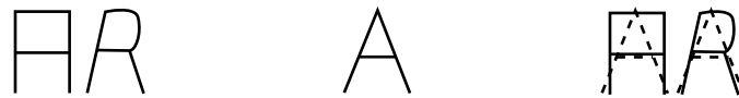
FIG. 2.13 – Erreur de reconnaissance de caractère. À gauche un A et un R, au milieu le gabarit d'un A. À droite le gabarit du A a tendance à s'apparier plutôt avec le R qu'avec le A.
