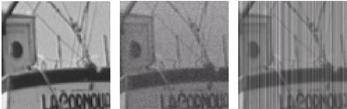
figure I.18 Image d'origine et avec du bruit : de type pixel et de type colonne
