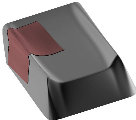
FIG. 5.20 – Courbes et surface reconstruites à partir du prototype
