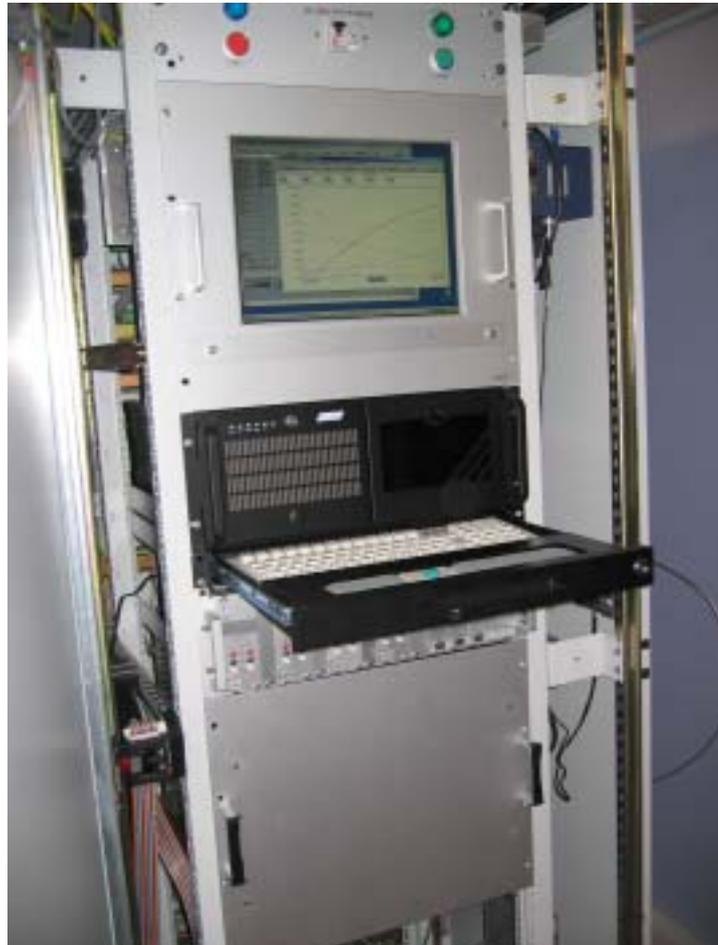
*Figure II.6: Vue de la partie analyseur du CARIBOU. Cette baie électrique est régulée en température et comprend l'analyseur CO<sub>2</sub> (en bas) et le système de contrôle associé (PC). Les composants industriels ont été choisis pour leur robustesse et leur maintenance aisée.*
