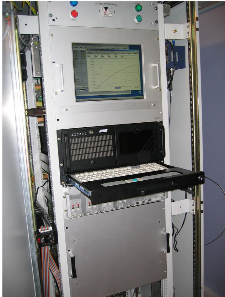
Figure II.6: *Vue de la partie analyseur du CARIBOU. Cette baie électrique est régulée en température et comprend l'analyseur CO<sub>2</sub> (en bas) et le système de contrôle associé (PC). Les composants industriels ont été choisis pour leur robustesse et leur maintenance aisée.*
