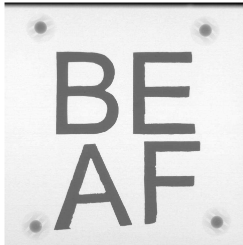
(c) Image RX de la mire : 4 points d'intérêt + 4 lettres
