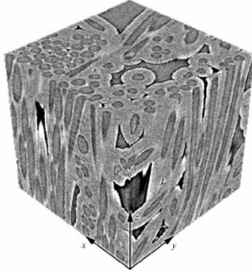
Fig.11. : Tomographie d'un composite fibreux (European Synchrotron Radiation Facility).
