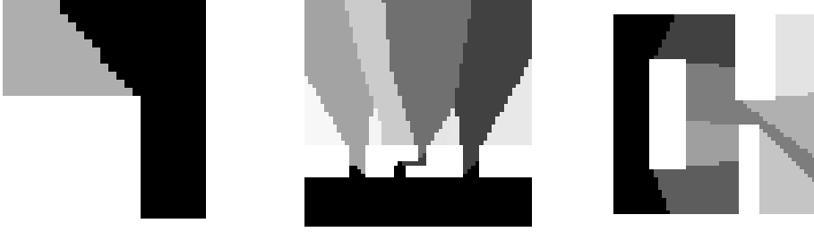
FIG. 4.36 –: Diagramme de visibilité discrète : tous les pixels de même couleur sont dans la même classe d'équivalence de visibilité, les domaines et points sources sont ceux de la figure 4.35.
