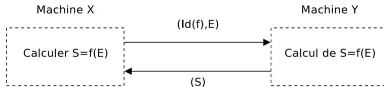
FIG. 7.1 – Principe du transfert de l'exécution d'une fonction  $S = f(E)$ .
