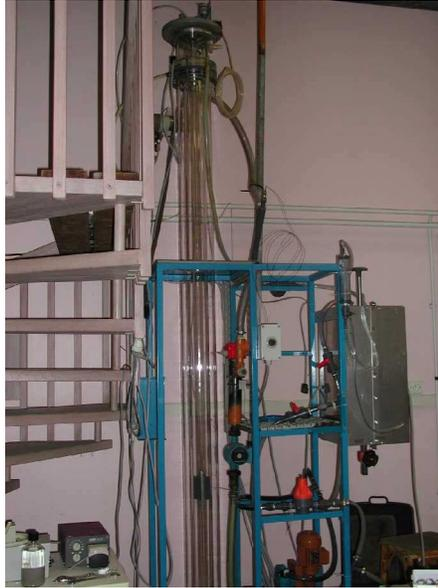
FIG. 3.5 – Réacteur à lit fluidisé
