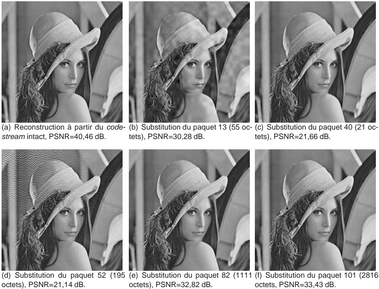
FIG. 3.10: Effets de la substitution d'un paquet sur les qualités visuelles objective et subjective de la reconstruction de l'image Lena JP2 1 bit/pixel (6 résolutions, 19 couches, 1 composante, 114 paquets).
