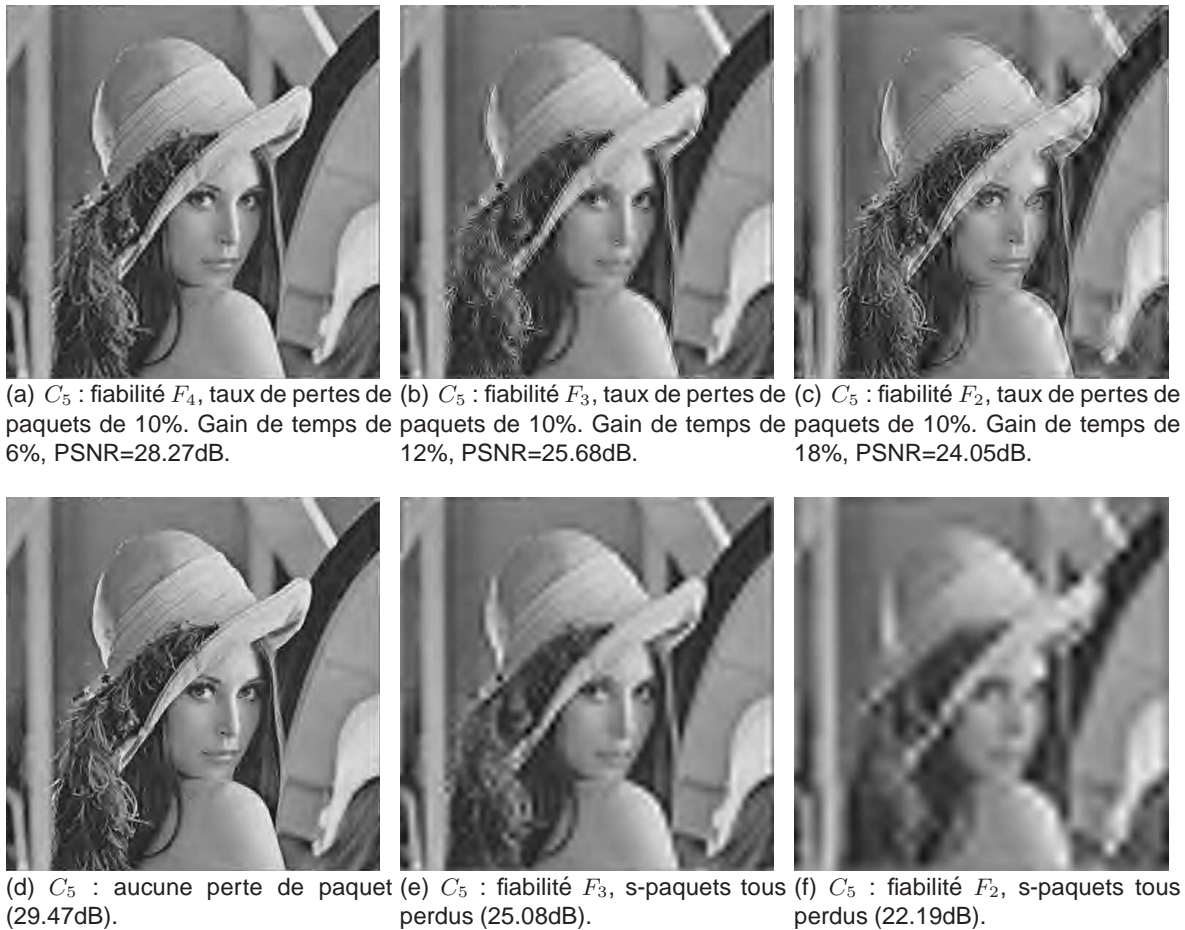
FIG. 4.16: Taux de compression élevé C_5 : images Lena et tolérance aux pertes de paquets en fonction de la politique de fiabilité.
