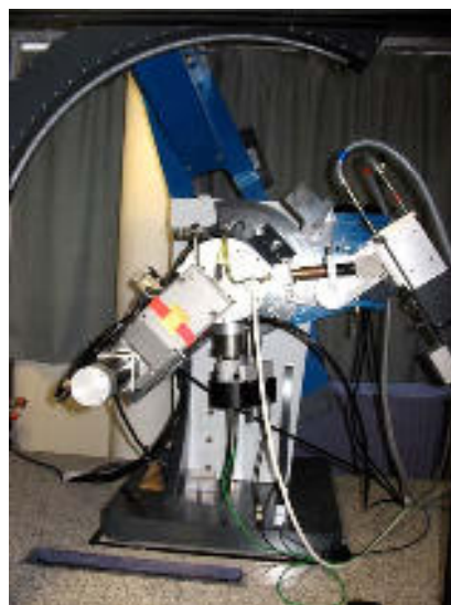
Photo IV.2 : Goniomètre Inel au LEMMA
