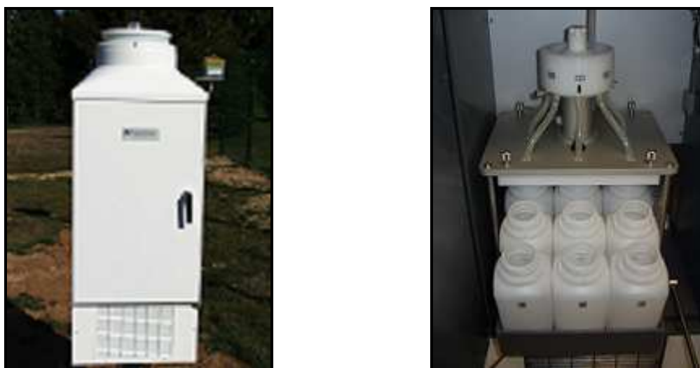
Figures II-2.2 : Collecteur de précipitation du dispositif MERA (depuis 2002).
