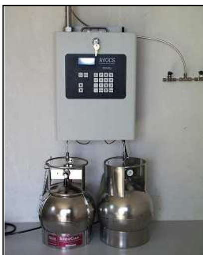
Figure II-2.4 : Préleveur AVOCS en fonctionnement dans 3 stations MERA
