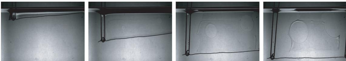
FIG. 4.3: Un fil de rayon 250  $\mu\text{m}$  est plongé dans un bain d'huile silicone de viscosité 500 mPa.s. La surface du bain est fracturée, et un film d'air est entraîné. Il est possible de suivre la rétraction du film sur les bords, ou dans les trous qui y apparaissent.
