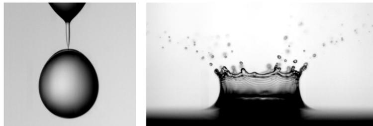
FIG. 1: Quelques exemples d'interfaces fortement déformées. À gauche, une goutte d'eau de diamètre 2 mm environ se détache d'un tuyau. Elle laisse derrière elle un filament dont l'extrémité est très acérée. À droite, suite à un impact, la surface d'un bain prend une forme de couronne, et de minuscules gouttelettes sont éjectées.
