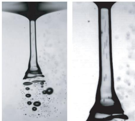
FIG. 7.3: Jet d'huile silicone inséminé avec des particules de  $80\ \mu\text{m}$  de diamètre. Les particules de polystyrène présentes dans le jet laissent sur les images des traces qui permettent de mesurer leur vitesse. Le rayon du jet vaut  $400\ \mu\text{m}$ . Le temps d'exposition est  $1/4000\ \text{s}$ .
