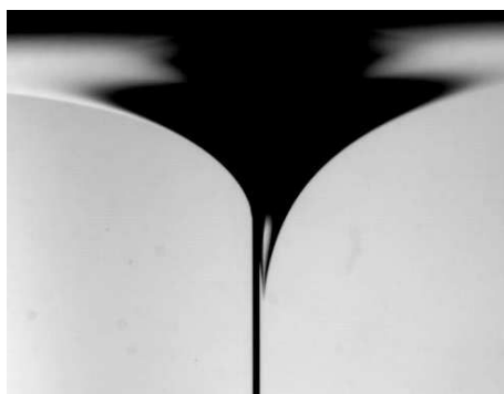
FIG. 6.16: Fibre de 75 \mu\text{m} de rayon plongée dans un bain d'huile silicone de viscosité 970 \text{ mPa.s} . L'interface forme une pointe tridimensionnelle.
