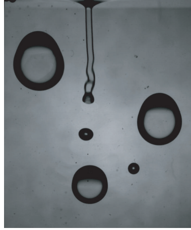
FIG. 3.4: Antibulles dans un bain d'huile silicone 100 fois plus visqueuse que l'eau. L'air drainé par gravité forme un renflement au sommet des antibulles.
