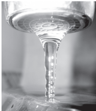
FIG. 8.6: Impact d'un jet d'eau sur un support solide. Pour une vitesse suffisamment faible, on observe une série d'ondes stationnaires proche du point d'impact. Le diamètre du robinet vaut 22 mm. Au point d'impact, après une chute d'environ 2 cm, la vitesse de l'eau est de l'ordre de 0,6 \text{ m.s}^{-1} .
