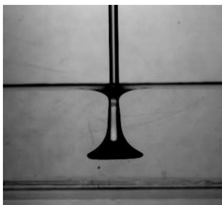
FIG. 6.17: Jet d'huile silicone 1000 fois plus visqueuse que l'eau tombant sur un bain d'huile peu profond. Il se forme autour du jet une trompette d'air stable, mais sans que des bulles ne soient émises à l'embouchure de la trompette. Le rayon du jet est de l'ordre d'un millimètre.
