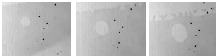
FIG. 4.17: On observe parfois l'ouverture d'un trou circulaire régulier dans un film d'air baignant dans une huile silicone 10000 fois plus visqueuse que l'eau. La barre noire représente 2 mm.
