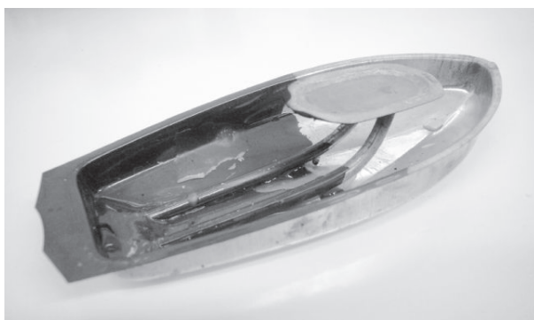
FIG. A.1: Système de propulsion du bateau pop-pop. Le bateau mesure une dizaine de centimètres de long. On voit les deux tuyaux reliés par un réservoir plat. Ce dernier est recouvert d'une membrane métallique flexible.
