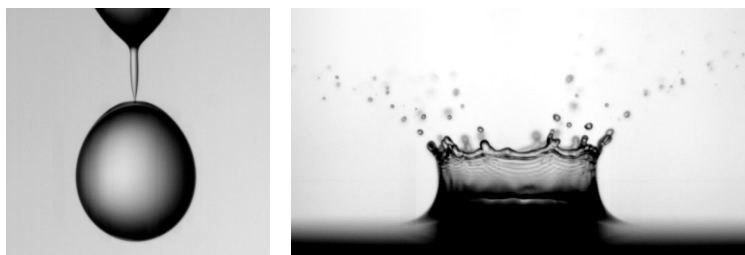
FIG. 1: Quelques exemples d'interfaces fortement déformées. À gauche, une goutte d'eau de diamètre 2 mm environ se détache d'un tuyau. Elle laisse derrière elle un filament dont l'extrémité est très acérée. À droite, suite à un impact, la surface d'un bain prend une forme de couronne, et de minuscules gouttelettes sont éjectées.
