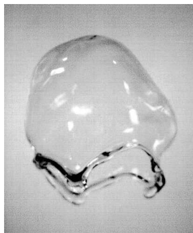
FIG. 2.1: Un exemple de forme transitoire en méduse. La vitesse de chute de cette goutte est d'environ 6,2 \text{ m.s}^{-1} , son diamètre initial vaut 1,8 \text{ cm} . La barre noire mesure 20 \text{ mm} .
