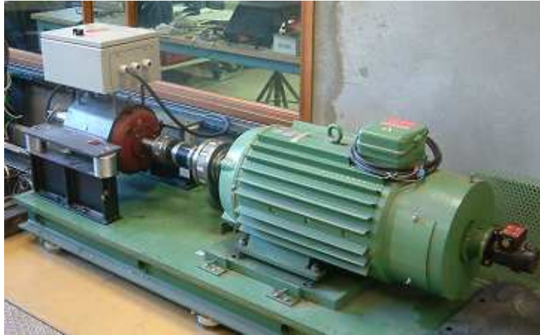
Fig. 2. 3 - Banc d'essai ; la machine synchrone à tester (gauche) et la machine à courant continu permettant son entraînement (droite).
