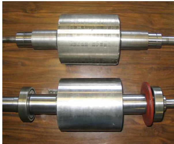
Fig. 2. 4 - Rotor aimanté (haut) et rotor équivalent en acier pour la mesure des pertes mécaniques (bas).
