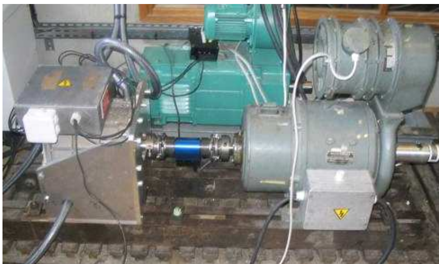
Fig. 3.3 - Banc d'essai, avec à gauche la machine synchrone à tester.
