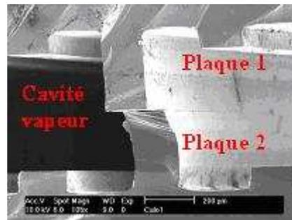
Figure 134 : Image MEB d'un dispositif brisé
