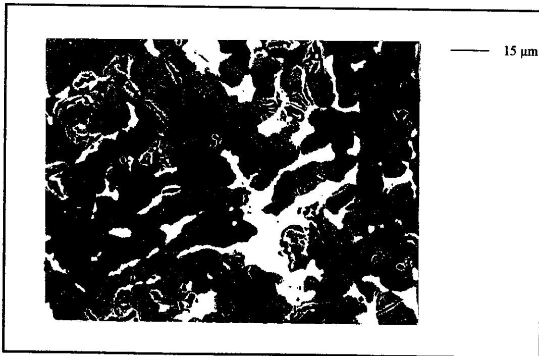
Photo iii.22: Echantillon 14, Zr_{33.3}Ni_{40}Cr_{26.6} (0.6) recuit, image électronique. Dendrite isolée de Cr (noir), phase C15 (gris), Zr_7Ni_{10} (blanc).
