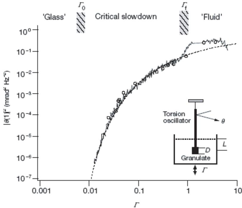
FIG. 1.18: Courbe représentant l'intensité du bruit à  $f = 1$  en fonction de l'intensité de vibration  $\Gamma$ . Le trait discontinu est un ajustement de type VFT. (inset) Dispositif expérimental. [22]
