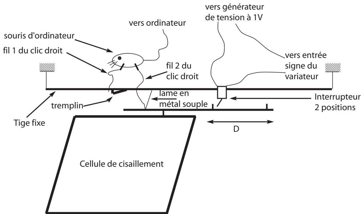
FIG. 2.10: Schéma des solutions apportées au problème du changement de sens de rotation du moteur ainsi qu'au problème du déclenchement de la prise d'image. Notons que la distance  $D$  définit approximativement l'amplitude du cisaillement.
