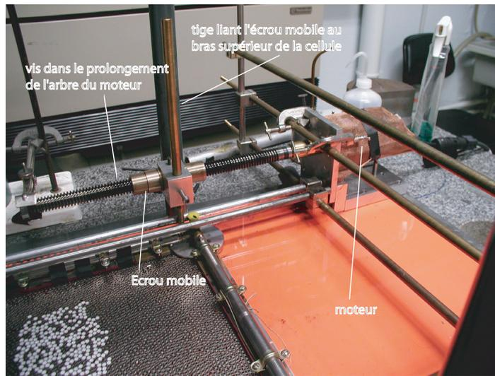
FIG. 2.7: *dispositif d'entraînement.*
