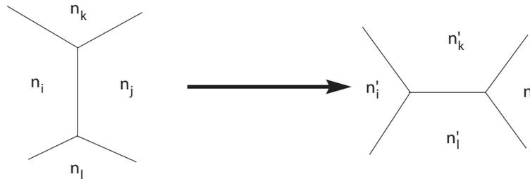
FIG. 5.9: Mécanisme de changement de voisins : 4 particules sont impliquées et le changement se traduit par la disparition du côté commun entre les cellules des grains  $i$  et  $j$  pour être remplacé par un côté entre les cellules des grains  $k$  et  $l$ . Dans le cas d'un réarrangement de type  $T_1$ , seules ces 4 particules sont concernées, ce qui implique :  $n'_i = n_i - 1$ ,  $n'_j = n_j - 1$ ,  $n'_k = n_k + 1$  et  $n'_l = n_l + 1$ .
