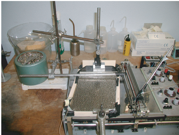
FIG. 2.1: Photo du premier prototype. Nous voyons, en haut, la pince qui maintient le bord supérieur à distance fixe du bord inférieur et, en bas, le serrage du bord inférieur.
