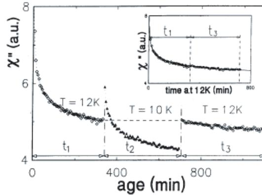
FIG. 1.8: Partie imaginaire de la susceptibilité magnétique d'un verre de spin subissant un cycle en température  $12\text{K}/10\text{K}/12\text{K}$ , sous  $T_g$ . Dans l'insert, on voit que les deux parties à  $12\text{K}$  se raccordent si on supprime la partie passée à  $10\text{K}$ . ??
