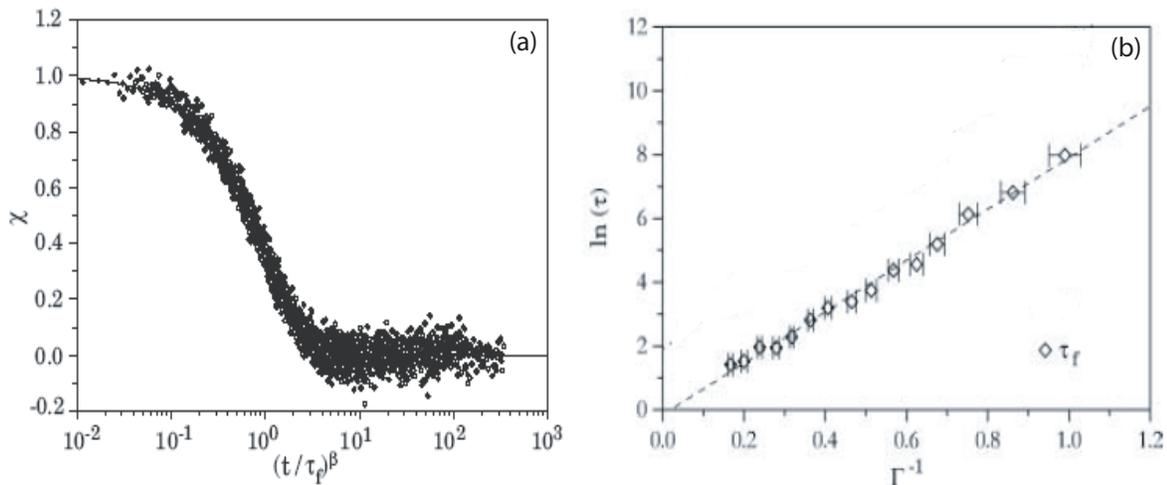
FIG. 1.13: (a) Courbes expérimentales de compaction (points) pour 15 valeurs différentes de  $\Gamma$  en fonction de  $u = (t/\tau_f)^\beta$  et ajustement en  $\exp(-u)$  (trait plein). (b) Logarithme du temps de relaxation  $\tau_f$  en fonction de  $1/\Gamma$  et ajustement linéaire (c'est-à-dire décrivant une loi d'Arrhénius). [18]
