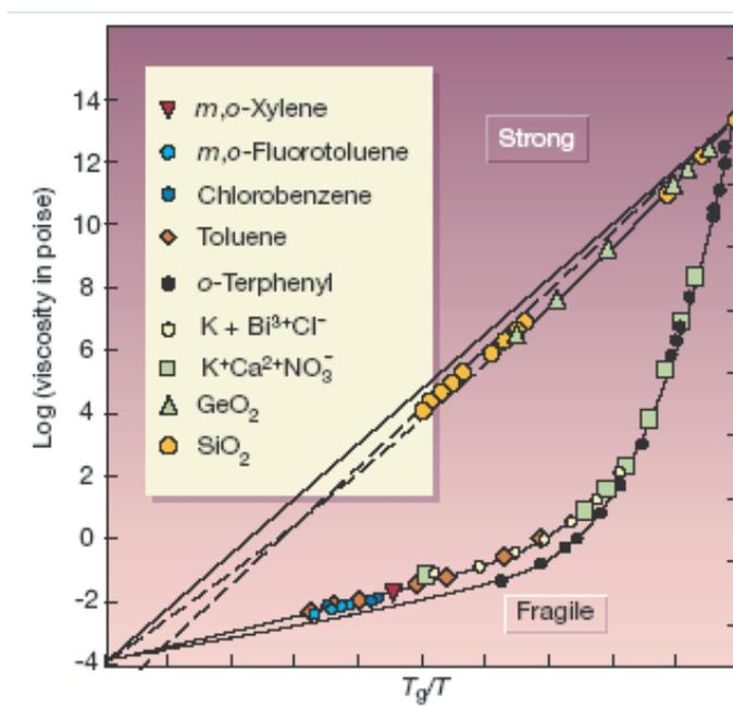
FIG. 1.2: Courbes représentant le logarithme de la viscosité en fonction de  $T_g/T$  pour différents systèmes vitreux. Les systèmes dont la courbe est une droite sur cette figure (loi d'Arrhénius) sont des verres forts, les autres sont des verres fragiles (loi VFT). [2]
