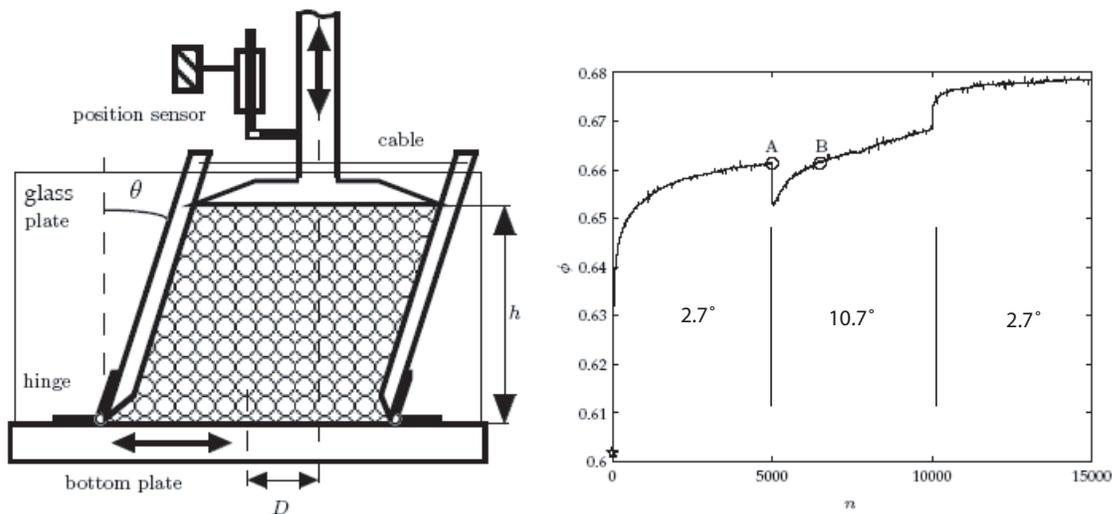
FIG. 1.17: (a) Schéma de l'expérience d'O. Pouliquen. (b) Courbe de compaction obtenue pour une amplitude de cisaillement valant successivement  $2.7^\circ$ ,  $10.7^\circ$ , puis à nouveau  $2.7^\circ$ . [21]
