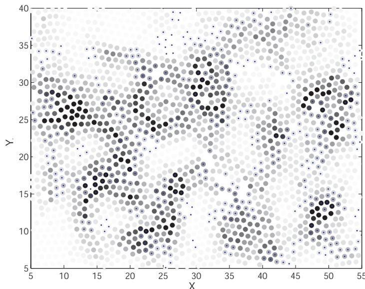
FIG. 5.21: Zones de déformation non-affine pendant un intervalle de temps (1000), le niveau de gris codant  $D_{min}^2$  (plus le point est foncé, plus la déformation s'éloigne d'une déformation constante). Les points bleus sont les particules ayant changé de nombre de voisins plus de 100 fois pendant cet intervalle.
