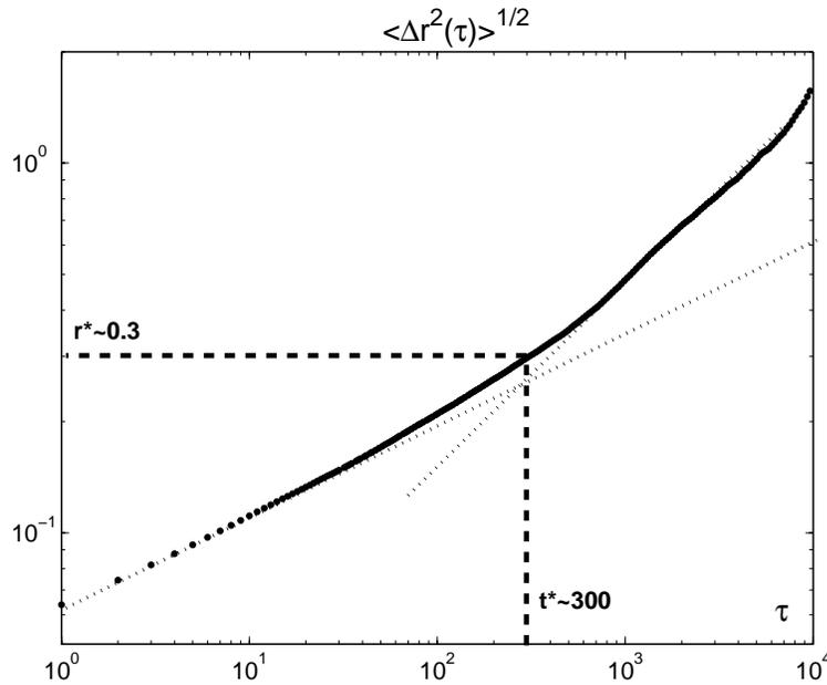
FIG. 3.6: Courbe de diffusion  $\sigma(\tau) = \sqrt{\langle \Delta r^2(\tau) \rangle}$ ; Les lignes en pointillés montrent les pentes  $1/4$  et  $1/2$ ; les lignes en tirets indiquent la position du changement de régime qui permet de déterminer  $r^*$  et  $t^*$ .
