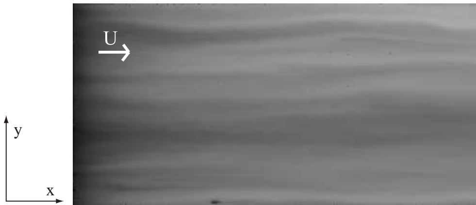
Figura 3.10: Mapa en niveles de gris de los tiempos de tránsito normalizados t^* = \overline{t(x, y)}U/x ( Pe=150 , solución de 1000 ppm). Esta normalización permite saber en cada posición si el tiempo de tránsito es mayor o menor que el asociado a la velocidad media U del frente de desplazamiento. El flujo es de izquierda a derecha. Las regiones oscuras (claras) corresponden a zonas donde t^* < 1 ( t^* > 1 ). El campo de visión es de 16 \times 7.5 cm, y la inyección se encuentra a 1 cm a la izquierda del borde izquierdo.
