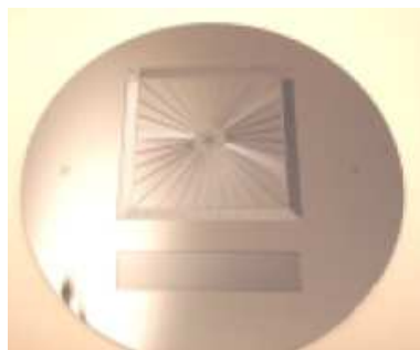
Figure 84 : Photographie d'une plaque constituant le caloduc gravé sur un wafer en silicium
