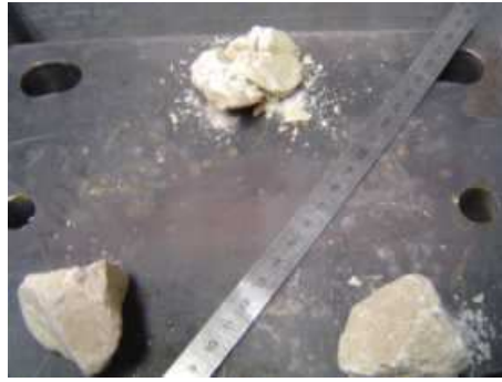
FIG. F.1 – Ballast de calcaire écrasé.
