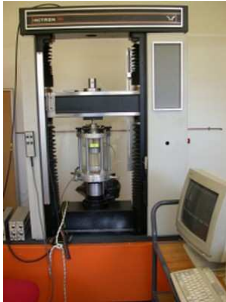
FIG. J.6 – Photographie de la presse INSTRON du LMA montée ici en compression.
