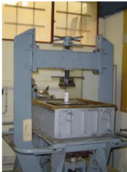
FIG. J.1 – Compression avec la grande boîte de Casagrande équipée d'une plaque rotulée.
