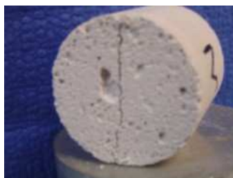
FIG. J.4 – Rupture en essai brésilien.
