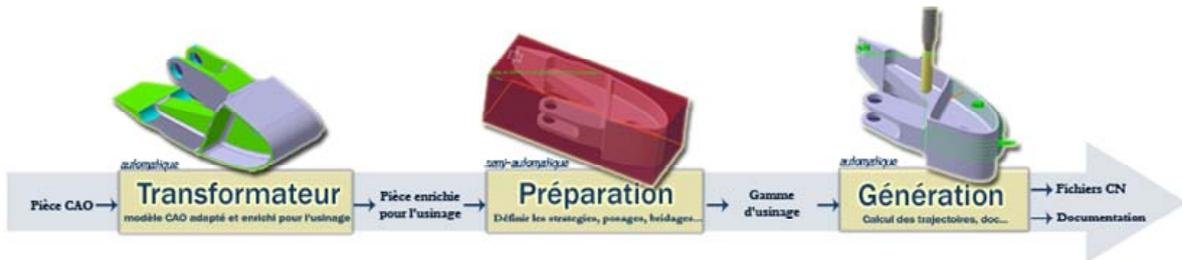
Figure 2. La chaîne du processus USIQUICK
