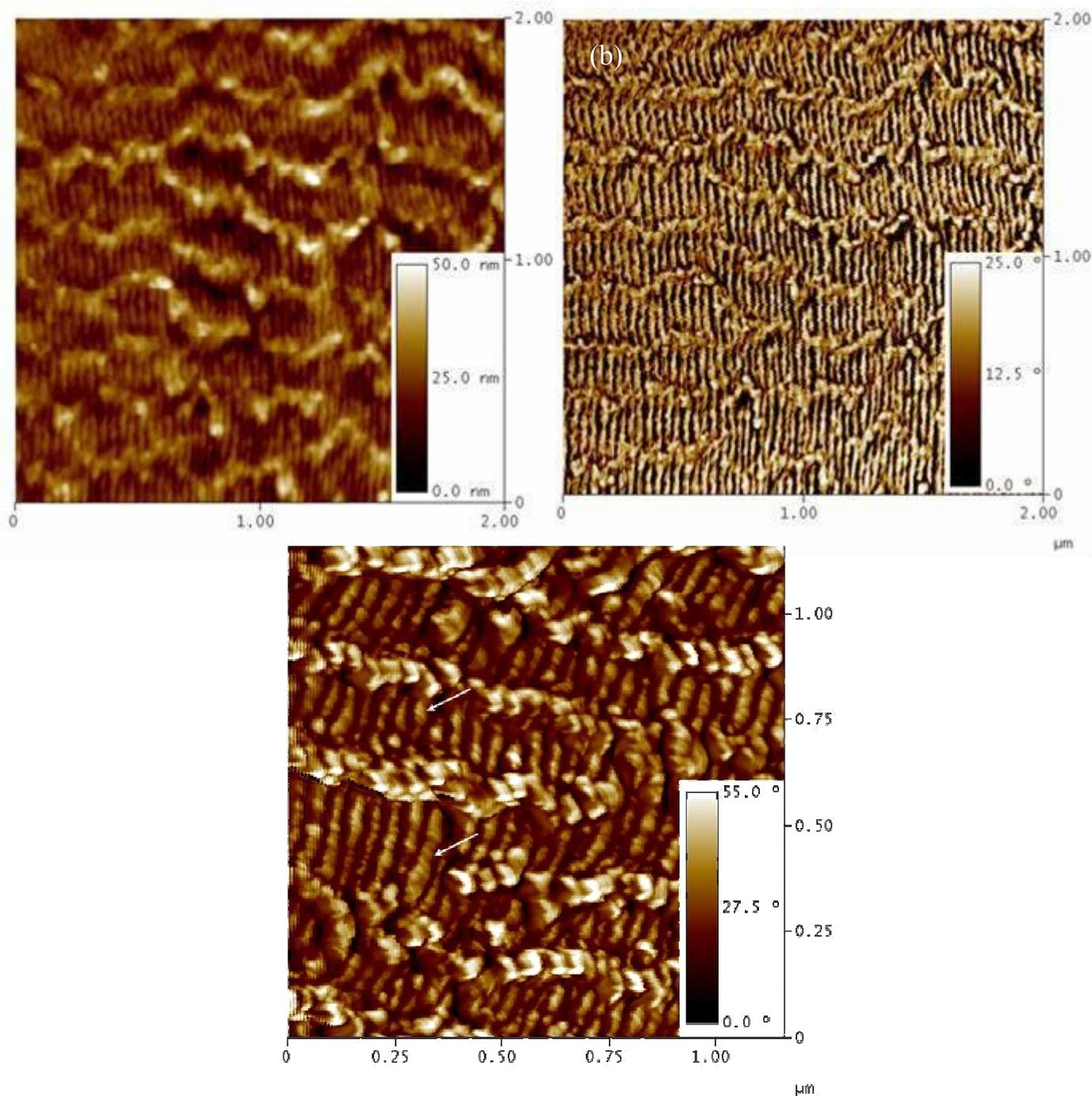
Figure IV-23 : Images AFM de la surface du film microtomé du copolymère linéaire PS<sub>24</sub>-*b*-PBLG<sub>104</sub> : (a) en topographie, (b) en phase et (c) images AFM zoomée en phase.
